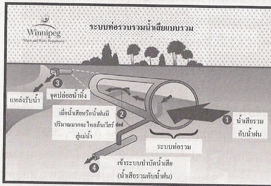
ท่อรวมน้ำเสียแบบรวม
